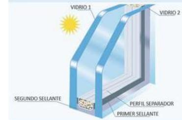
Carpintería compuesta por un sistema de doble vidrio con cámara de aire interior 6/8/6.
